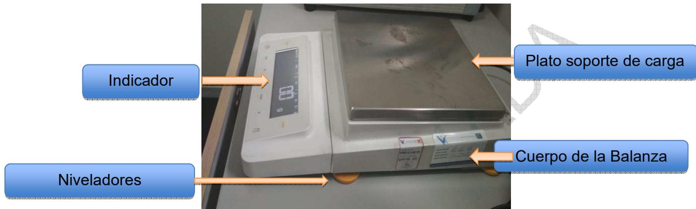
Nivelar la balanza utilizando los niveladores del instrumento y observar indicador de nivel.
