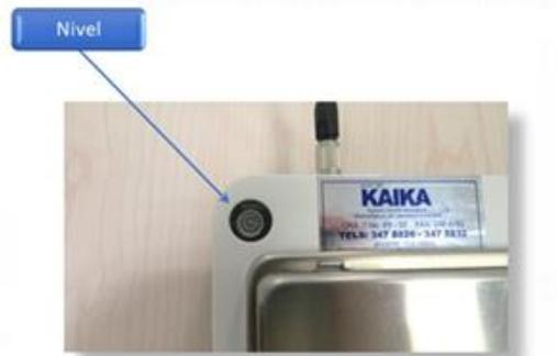
Limpiar cada parte de la balanza, plato, display, soporte de estabilidad y cuerpo general, con una bayetilla humedecida con alcohol al 95%
