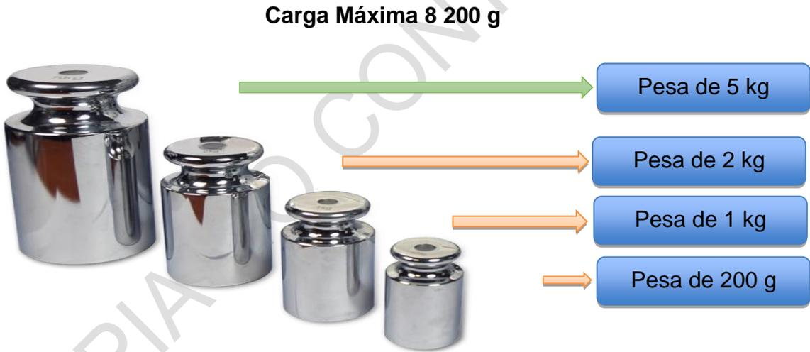
**Clase de Exactitud y Rangos de Medición de la Balanza**
